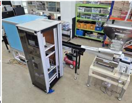
간마늘 선별 자동화 전체 시스템
