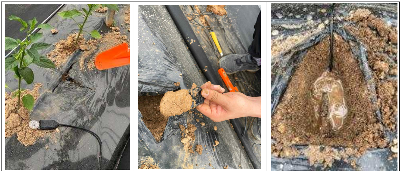
그림 2. 고추 관비재배 시 수분장력센서 설치 방법
